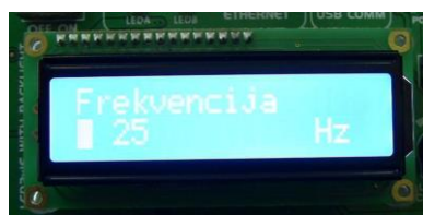
Slika 2.3. Izgled displeja prototipa uređaja Intermed 2 za odabir frekvencije
