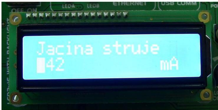
*Slika 18. Izgled displeja prototipa uređaja Intermed 2 za odabir jačine struje*
