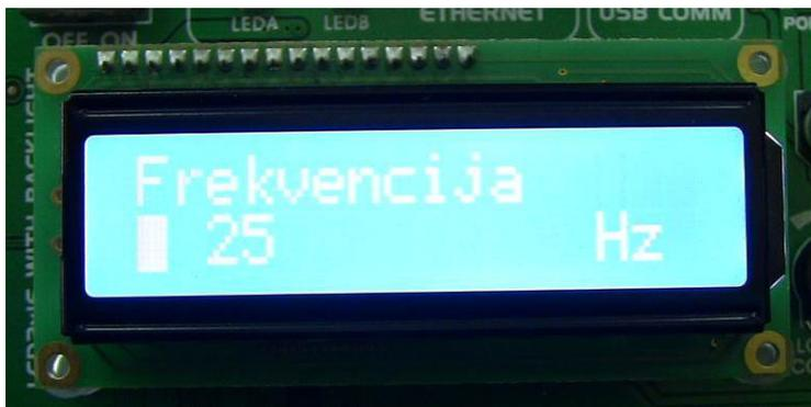
*Slika 19. Izgled displeja prototipa uređaja Intermed 2 za odabir frekvencije*
