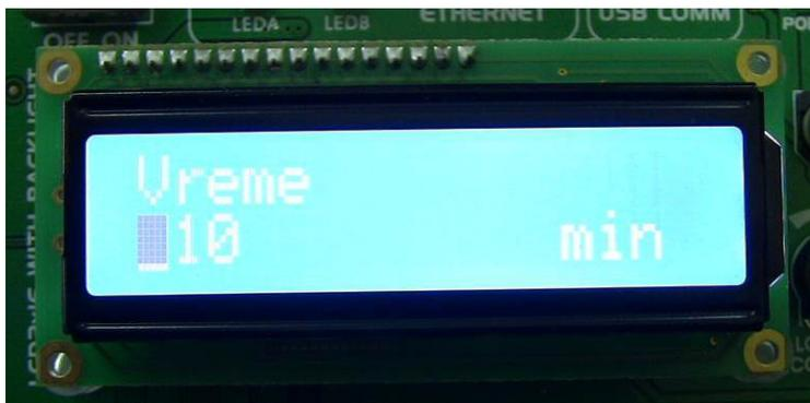
*Slika 17. Izgled displeja prototipa uređaja Intermed 2 za načina odabir vremena trajanja terapije*
