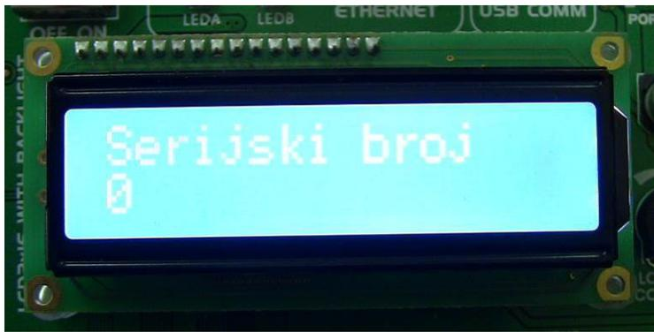
*Slika 27. Izgled displeja prototipa uređaja Intermed 2 za prikaz serijskog broja uređaja*
