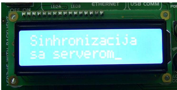
*Slika 34. Izgled displeja prototipa uređaja Intermed 2 za sinhronizaciju sa serverom*
