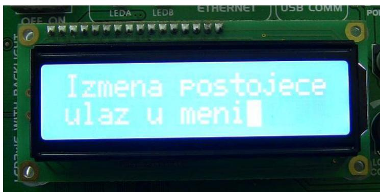
*Slika 32. Izgled displeja prototipa uređaja Intermed 2 za izmenu postojeće terapije*
