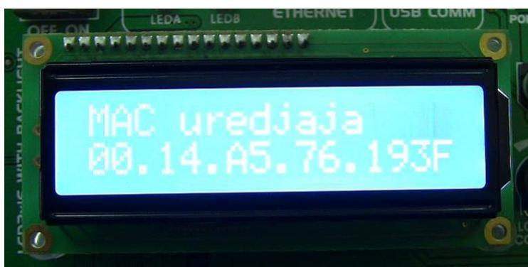
*Slika 25. Izgled displeja prototipa uređaja Intermed 2 za prikaz MAC adrese uređaja*
