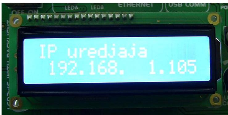
*Slika 23. Izgled displeja prototipa uređaja Intermed 2 za prikaz IP adrese uređaja*
