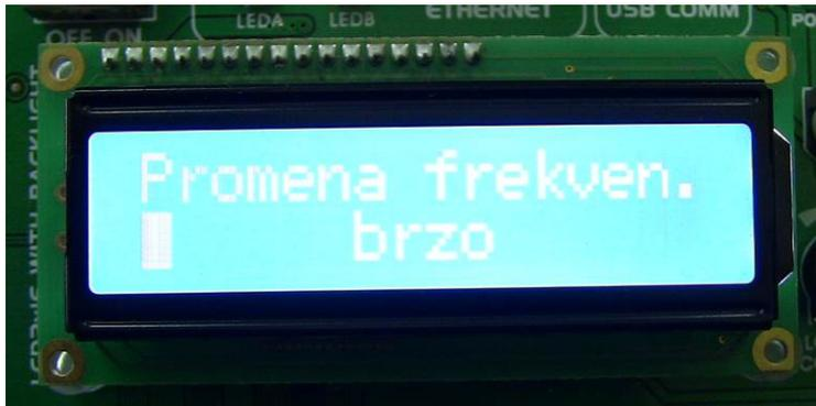
*Slika 16. Izgled displeja prototipa uređaja Intermed 2 za odabir načina promene frekvencije*
