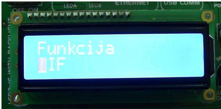
*Slika 15. Izgled displeja prototipa uređaja Intermed 2 za izbor tipa struje*
