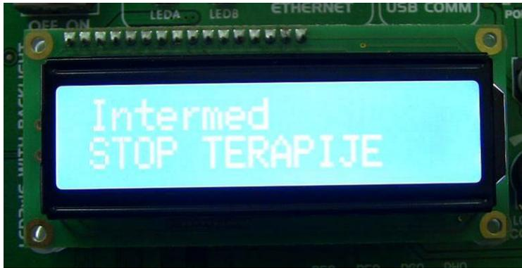
*Slika 39. Izgled displeja prototipa uređaja Intermed 2 sa informacijom o prekinutoj terapiji*
