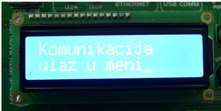
*Slika 21. Izgled displeja prototipa uređaja Intermed 2 za ulaz u meni sa podacima o mrežnim parametrima*
