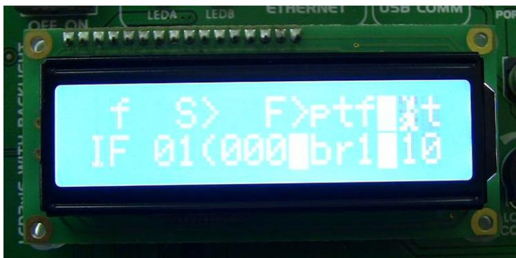
*Slika 37. Izgled displeja prototipa uređaja Intermed 2 sa odabranim parametrom F*
