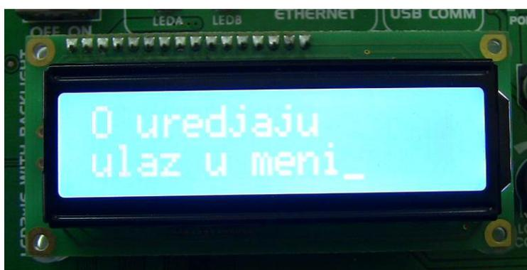
*Slika 26. Izgled displeja prototipa uređaja Intermed 2 sa menijem za prikaz podataka o uređaju*
