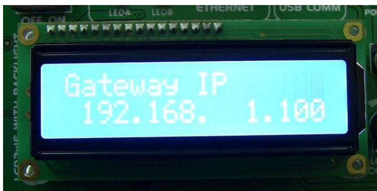
*Slika 24. Izgled displeja prototipa uređaja Intermed 2 za prikaz IP adrese servera*
