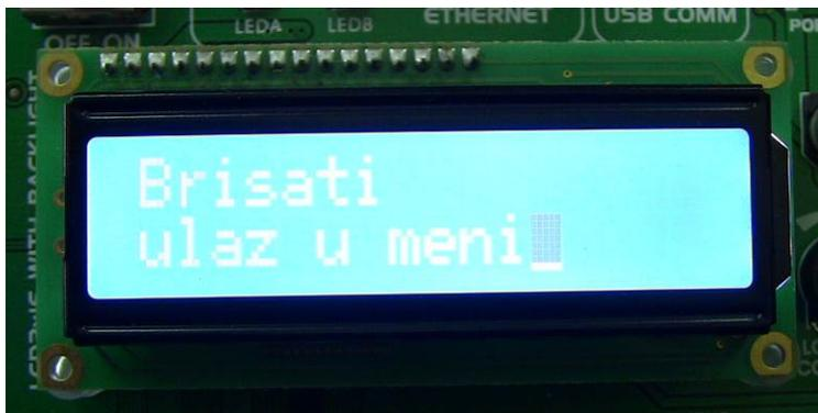
*Slika 33. Izgled displeja prototipa uređaja Intermed 2 za brisanje terapije*
