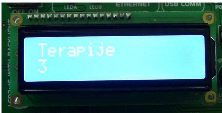
*Slika 29. Izgled displeja prototipa uređaja Intermed 2 za prikaz broja izvršenih terapija*
